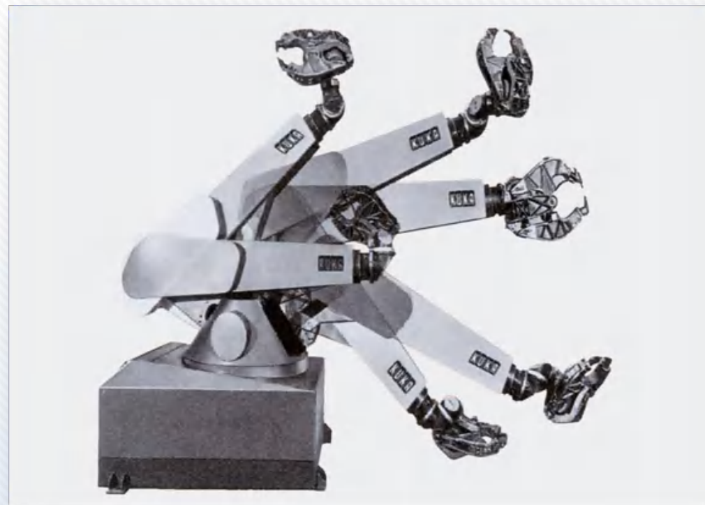
1973 年,KUKA公司推出的世界第一台拥有六个机电驱动轴的工业机器人， FAMULUS
